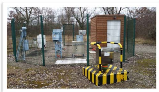
Boîtier situé devant une station météo (propriétaire CNPE de Fessenheim) équipé pour la télétransmission et la gestion de l'humidité
